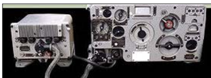
Sl. 38c. Priključenje tranzistorskog pretvarača BP-26 na radio-uređaj R-123
