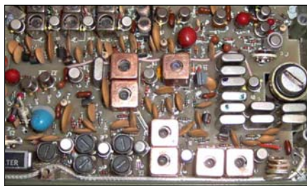
Sl. 43d. Kristalni oscilator u VVF RU UKT FM 66/13
