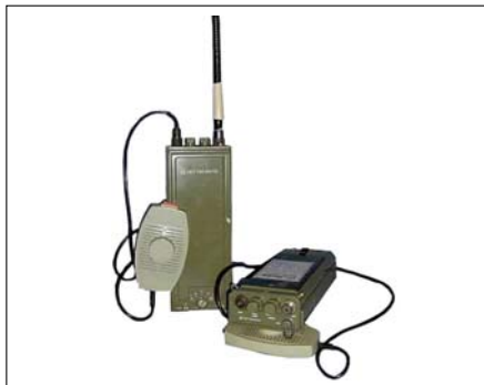
Sl. 43b. Ručni VVF RU UKT FM 66/13i, koji je proizveden u fabrici "Ei" Niš, krajem 60-tih godina XX veka
