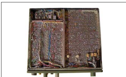
Sl. 41e. Pogled sa donje strane na štampane pločice od VVF RU UKT FM 66/17
