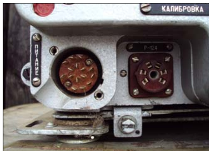
Sl. 38a. Detalj na prednjoj ploči uređaja R-123 za priključenje napojnog kabla iz tranzistorskog pretvarača BP-26
