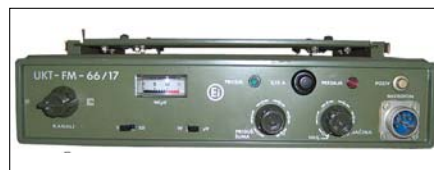
Sl. 41. VVF primopredajnik UKT FM 66/17
