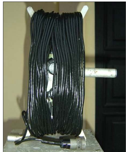
Sl. 40d. Kabl za retranslaciju KS-28 namotan na motalici ML-6
