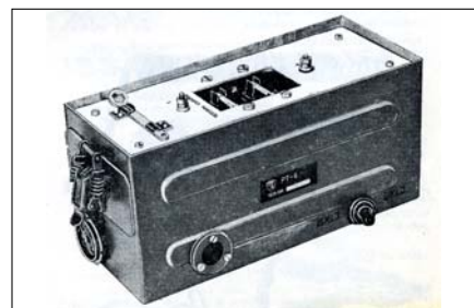
Sl. 40l. Pretvarač napona PT-6 iz kompleta RUP-12
