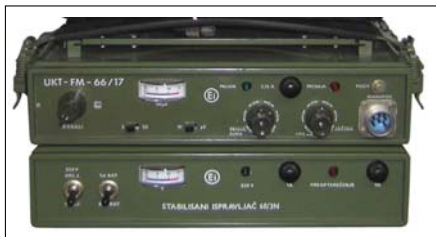
Sl. 41b. Stacionarna varijanta VVF RU UKT FM 66/17
