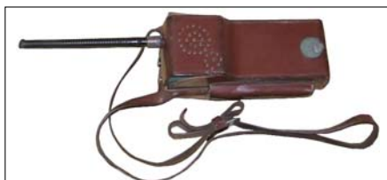
Sl. 43a. VVF RU UKT FM 66/13 u kožnoj torbici radi zaštite i lakšeg nošenja preko ramena
