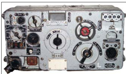
Sl. 38. Ruski tenkovski VVF radio-uređaj R-123M
