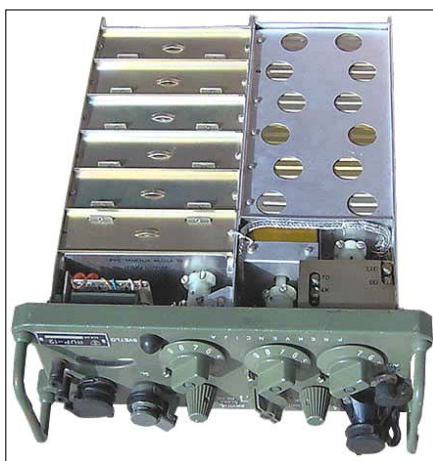
Sl. 40h. Primopredajnik PD-7 iz kompleta VVF RU RUP-12 izvađen iz kutije - pogled odozdo
