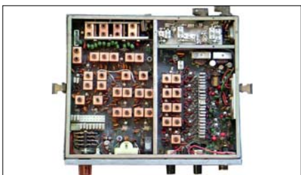
Sl. 41d. Pogled odozgo na štampane pločice u VVF RU UKT FM 66/17
