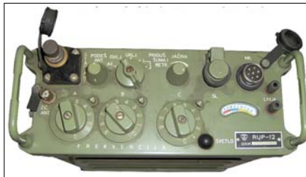
Sl. 40a. Prednja ploča VVF RU RUP-12, proizvedenog u fabrici "Rudi Čajavec" Banja luka, 1966. godina
