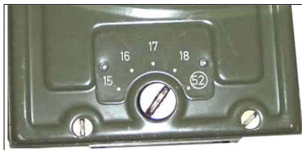
Sl. 43e. Oznake radnih kanala na ručnom VVF RU FM 66/13i; repetitorski kanal je bio onaj sa oznakom "52"
