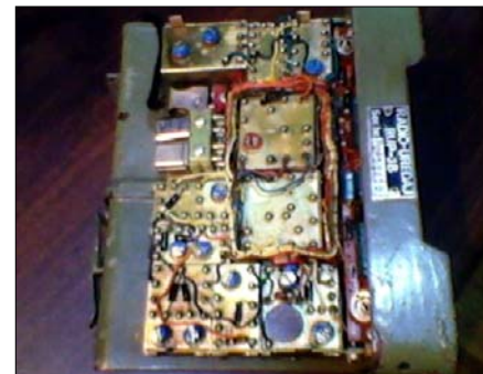
Sl. 26a. Primopredajnik RUP-3B izvađen iz kućišta-pogled odozgo
