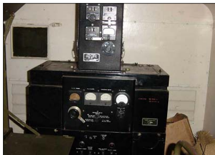
Sl. 29b. Pogled na VF TX iz radio-sistema SCR-399-A u radio-kabini
