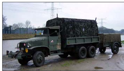
Sl. 29. Američki teretni kamion GMC sa nabacnom kabinom i rVF radio-sistemom SCR-399-A
