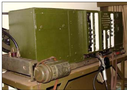
Sl. 33. VF FM radio-uređaj SCR-528-A smešten u terensko vozilo Dodge
