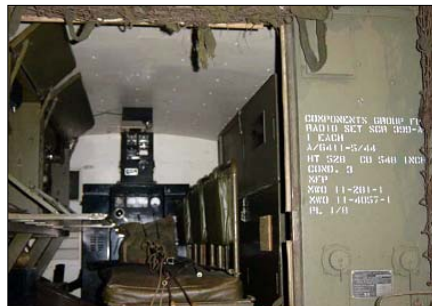
Sl. 29a. Pogled na unutrašnjost nabacne radio-kabine gde je smešten radio-sistem SCR-399-A, na Džemsu
