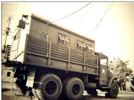
Sl. 28a. Nabacna kabina za radio-sistem SCR-499 na američkom teretnom m/v Džems (kamion GMC). Na ovoj slici je verzija nabacne kabine iz četrdesetih godina XX veka.
