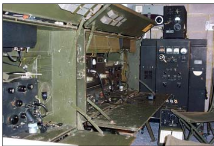
Sl. 28c. Unutrašnjost kabine od VF radio-sistema SCR-499
