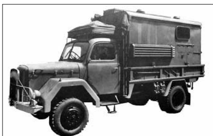
Sl. 37a. Nabacna kabina za upravljanje VPU sa RTpS-140, na domaćem teretnom m/v Dajc, odnosno TAM-5000D
