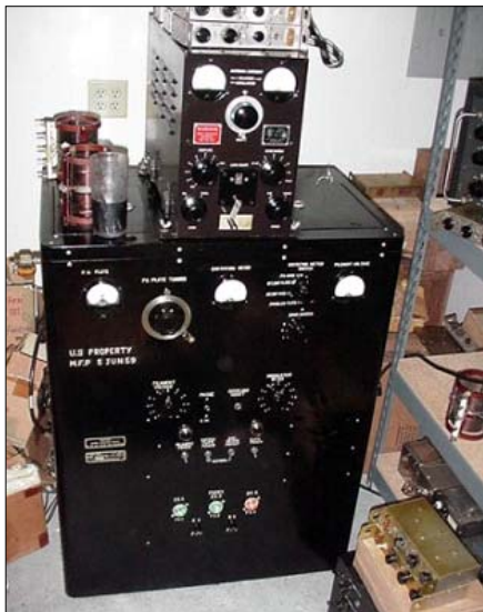
Sl. 28. VF TX BC-610 snage 400W
