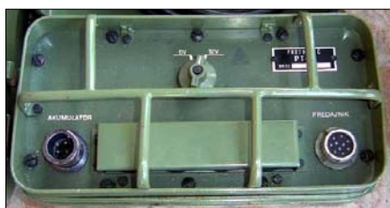
Sl. 27d. tranzistorski pretvarač napona PT-1 iz kompleta RU RUP-4
