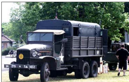
Sl. 28e. Kamion Džems sa prikolicom na kojoj je montiran agregat PE-95-G snage 10kW, koji je davao napon od 115V
