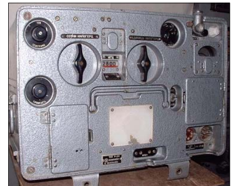
Sl. 34. Ruski VF radio-uređaj R-112 koji se nalazio u oklopnom transporteru BTR-50PU
