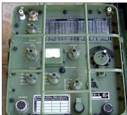
Sl. 27b. Predajnik RD-2, iz kompleta radio-uređaja RUP-4, slikan iz drugog ugla
