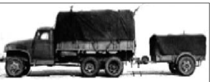
Sl. 28f. Džems sa prekrivenom nabacnom kabinom (prekrivena sa ceradom i utovarenim radio-sistemom SCR-499) i teretnom prikolicom (sa agregatorom) u položaju: SPREMAN ZA MARS
