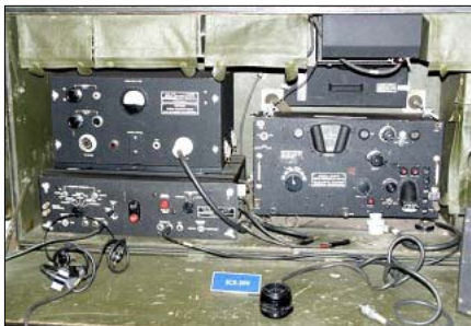
Sl. 28d. Drveni rek u kome su smešteni, levo-skroz gore, pojačavač govora, BC-614-E, a ispod njega se vidi upravljačka kutija JB-70A; desno je RX BC-342 iz radio-sistema SCR-499
