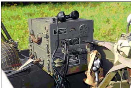
Sl. 31a. Radio-sistem SCR-610 montiran na američkom terenskom m/v Wilys (vlasništvo kolekcionara Francuza, Michel Duparet)
