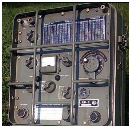
Sl. 27a. Predajnik RD-2 iz kompleta RUP-4
