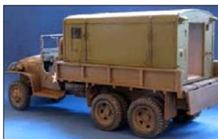
Sl. 28b. Novija verzija nabacne kabine na m/v Džems
