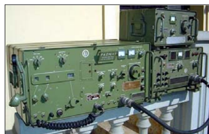
Sl. 10g. Primopredajnik PD-6 povezan na ispravljač MI-8 i antensku kutiju KA-2
