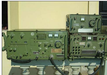
Sl. 9. Komplet primopredajnika RTU-100/v; levo je primopredajnik PD-6, a desno je antenska kutija, KA-2; ispod nje je ispravljač MI-8, za pogon PD-6
