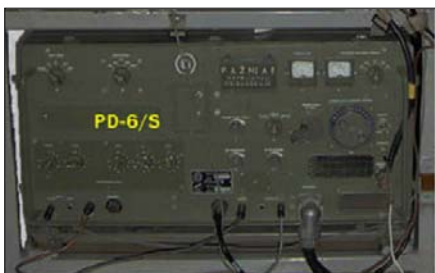
Sl. 10. Prednja ploča modificiranog primopredajnika PD-6 u koga je ugrađen sintezator frekvencija i zbog toga je ovaj novi uređaj dobio naziv PD-6/S; sintezator je imao pet preklopnika za tačno podešavanje TX-a
