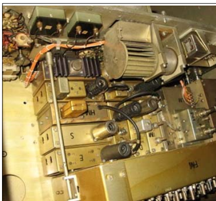
Sl. 10b. Unutrašnjost primopredajnika PD-6/S; vide se oznake na modulima
