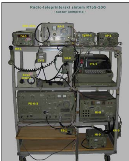
Sl. 10a. Sastav kompleta radio-teleprinterskog sistema RtpS-100
