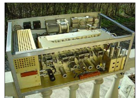
Sl. 9e. Pogled na PD-6 sa zadnje strane gde se u centralnom delu vidi RX; levo od njega je PA od TX sa 4xQE 05/40
