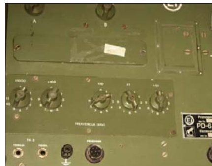
Sl. 10f. Pogled na prednju ploču i sintezator frekvencija od primopredajnika PD-6/S
