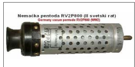
Sl. 24d. Nemačka elektronska cev koja je korišćena u RX TORN EB
