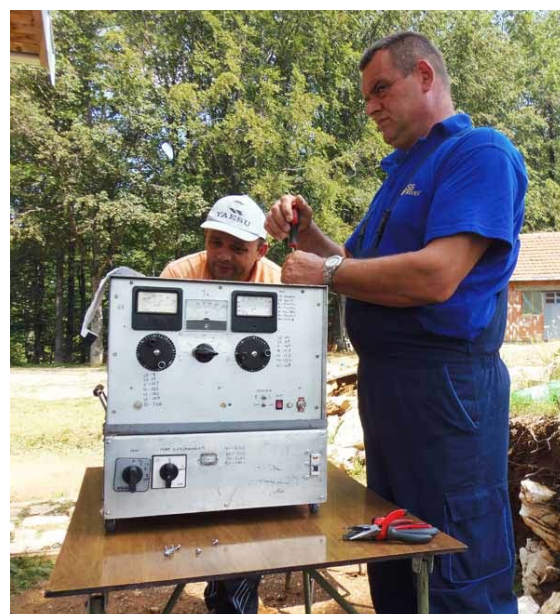
Po završetku takmičenja, Čoletu i Zoranu YU5ZM je bilo interesantno da pogledaju i linear sa GS35 koji radi od 1.8MHz do 50MHz
