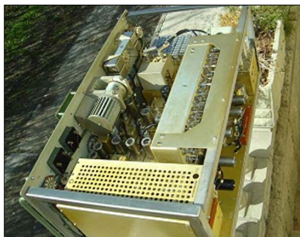
Sl. 9g. Pogled na PD-6 sa gornje strane, gde se vidi TX (levo ka prednjoj ploči) i RX
