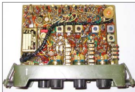
Sl. 70e. Primopredajnik iz kompleta RUP-33, pogled odozdo na kvarc kristale od sintezatora frekvencija
