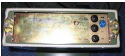
Sl. 77b. RT-20-TC6, pogled na donju stranu RU gde se priključuje baterija (na slici desno – džek plave boje)
