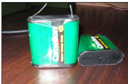
Sl. 68b. Suve baterije čija je oznaka „3R12 4,5V“, a koje se mogu koristiti u nuždi, za napajanje RUP-33
