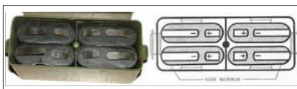
Sl. 68c. Položaj suvih baterija „3R12 4,5V“ u metalnom kućištu RUP-33
