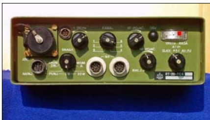
Sl. 77d. Prednja ploča RT-20-TC6, na kome je urađena fabrička prepravka (na prednjoj ploči se vidi novododata utičnica, desno od postolja za štap antenu)
