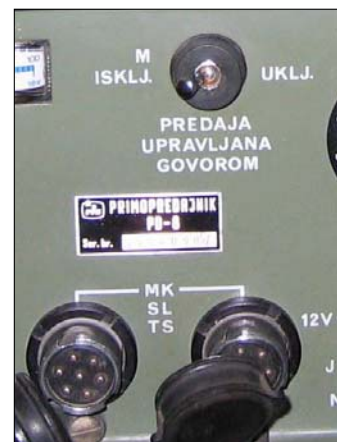
Sl. 79d. Pogled na NF priključnice na VVF/VF RU iz serija RUP
