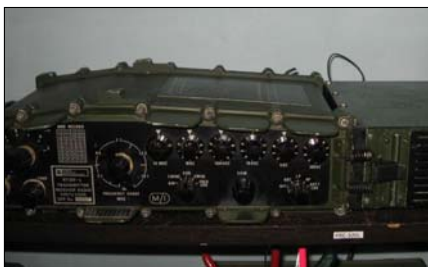
Sl. 66a. Još jedno rešenje ispravljača za RC-320L sa zvučnikom u istoj kutiji
