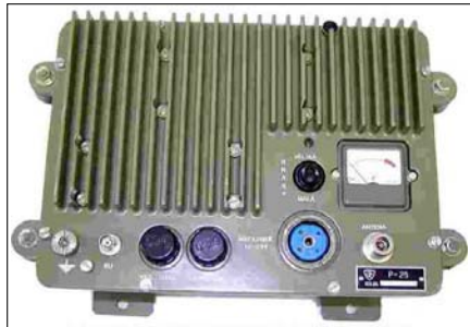
Sl. 74. Izgled pojačavača snage za RU-2 (listi ovaj pojačavač se mogao koristiti i u kombinaciji sa RUP-12)
