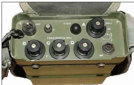
Sl. 68. Prednja ploča domaćeg VVF RU RUP-33 sa tri preklopnika (B, C i D) od sintezatora za izbor željene frekvencije
