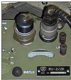
Sl. 73e. Poklopac-kratkospojnik na čepištu za priključenje KZU-63 RU-2/2K
