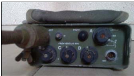
Sl. 68a. Prednja ploča RUP-33 sa postavljenom štap antenom
