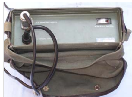
Sl. 77g. Ispravljač struje (sa gradske mreže 220V na jednosmernu struju napona 12,4V) za stacionarni rad, ND-10, sa priključenim pogonskim kablom ND-TC
