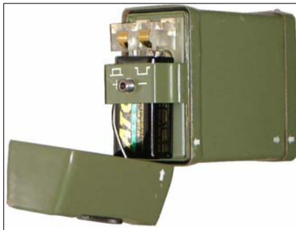
Sl. 72a. Pogled na donji poklopac od RP-6 i položaj pogonske baterije u njemu
