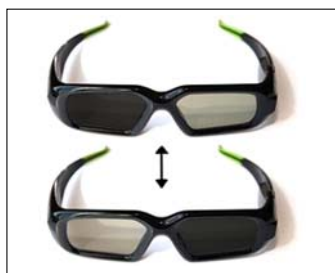
Slika 25. Izgled aktivnih naočara (Active shutter glasses)
