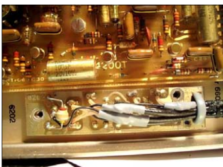
Sl. 51b. Pogled na sklop 4200T i na drugu filterarsku jedinicu 6202, sa koje je skinut poklopac, u VF uređaju PD-8
