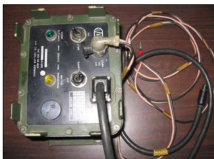
Sl. 64d. Punjač baterija (sa 14V jednosmernog napona prebacuje punjenje na 24V jednosmernog napona i onda puni baterije od uređaja) iz kompleta VF RU PRC-320L
