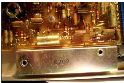
Sl. 51a. Pogled na sklop 4200T iz drugog ugla i na drugu filterarsku jedinicu čija je oznaka 6202, u VF uređaju PD-8
