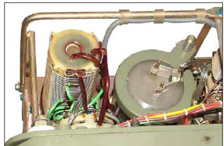
Sl. 60. Pogled na elektronsku cev u izlaznom pojačavaču snage kod predajnika RD-2 iz kompleta domaćeg VVF RU RUP-4-pogled odozgo (cev je desno od kalema)
