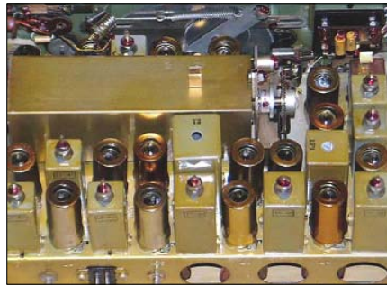
Sl. 57. Pogled na cevni primopredajnik iz VVF RU RUP-1B, gornja strana
