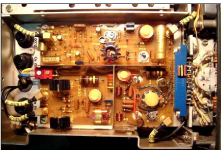
Sl. 61. Pogled na tranzistorski izlazni stepen kod domaćeg primopredajnika PD-8 iz kompleta VF RU RUP-15
