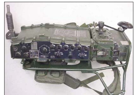
Sl. 64. Primopredajnik RT-320L engleske firme PLESSEY, iz kompleta VF RU PRC-320L, koga je JNA uvezla 1976. godine
