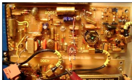
Sl. 53b. Pogled na sklop 4200T tj. na pločicu od MF-NF-ARP pojačavač i delove koje je Petar YU7NTG ugradio za S-metar u PD-8
