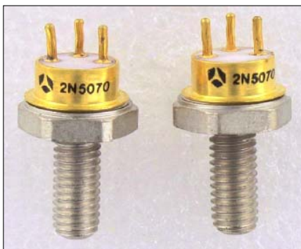
Sl. 63. Izlazni tranzistori 2N5070 iz domaćeg primopredajnika PD-8, koji daju snagu oko 15W
