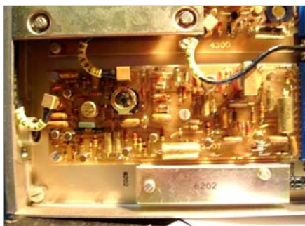
Sl. 51. Pogled na sklop 4200T odnosno na MF-NF-ARP pojačavač u VF uređaju PD-8
