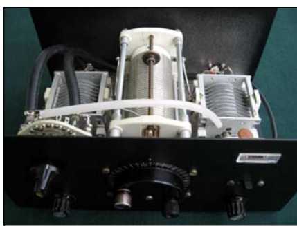
Sl. 49. Unutrašnjost antenskog tjunera za KT od YU7YZ
