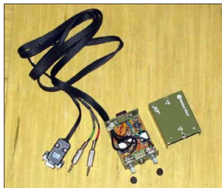
Sl. 58. SMB interfejs koga je konstruisao Brana YT7TU
