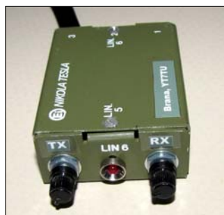
Sl. 60. Univerzalni SMB interfejs za vojne uređaje kod koga se samo menjaju kablovi za priključenje; konstrukcija Brana YT7TU
