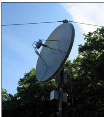
Parabolična antena na stubu, koju su proračunali, konstruisali i izradili Pavel YT7TA i Dragan YT7XT; u jednom fokusu imaju praktično dve antene
