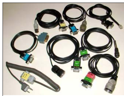
Sl. 61. Serija kablova za priključenje SMB interfejsa na vojne ili Vintage amaterske uređaje (a može se priključiti i na najsavremenije amaterske uređaje); kablove je izradio Brana YT7TU
