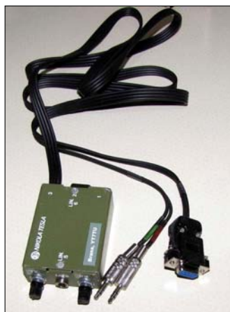
Sl. 59. Inrfejs za digitalne komunikacije sa SMB uređajima koji je konstruisao Brana YT7TU
