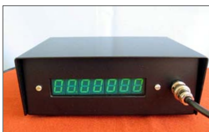
Sl. 50. Prednja strana digitalnog brojača frekvencije koga je konstruisao Vlada YU7YZ
