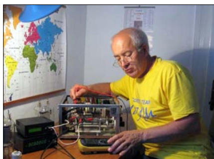
Sl. 51. Vlada, YU7YZ, proverava svoju konstrukciju antenskog tjunera za KT sa "home made" instrumentima
